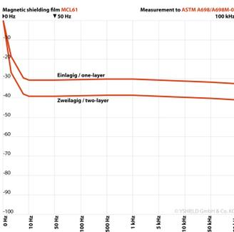
MCL61 ist unsere **neuartige Magnetfeld-Schirmfolie aus einer amorphen Cobaltlegierung** zur Abschirmung niederfrequenter magnetischer Wechselfelder, elektrischer Wechselfelder (NF) und hochfrequenter elektromagnetischer Felder (HF).
